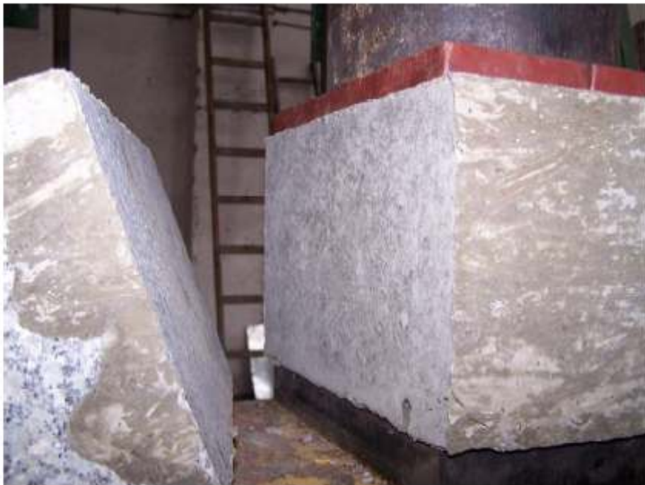
Fot. 2 Postać zniszczenia próbek od 1 do 3
