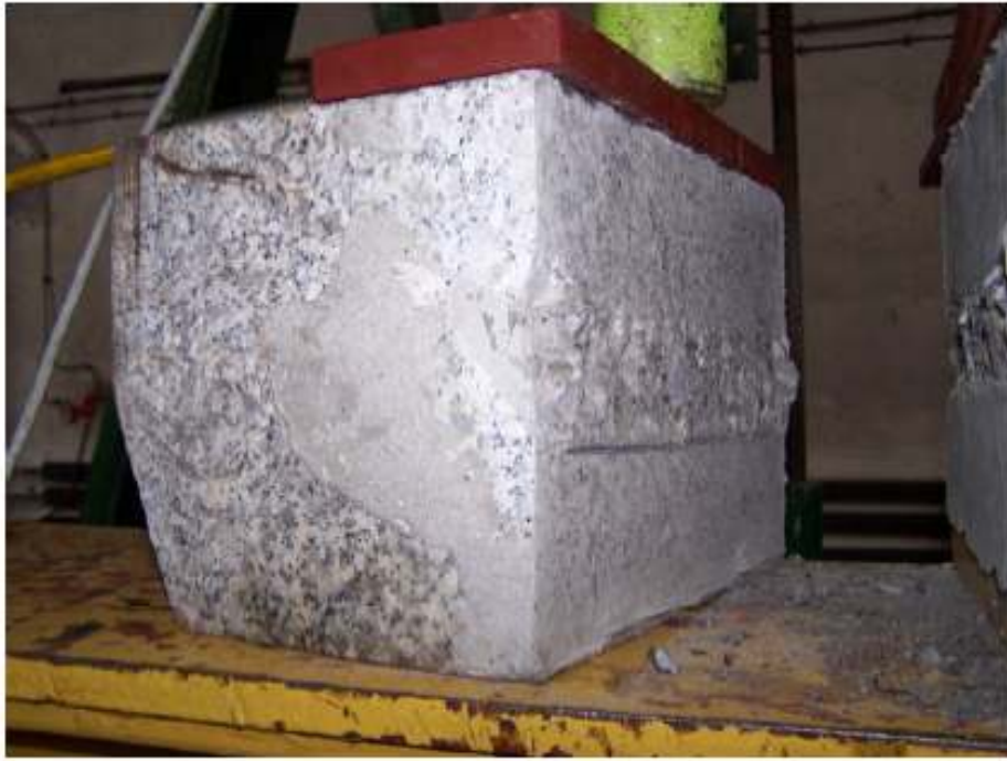
Fot. 5 Postać zniszczenia próbki 6
